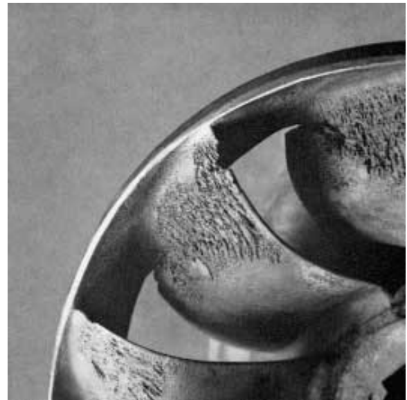
Durch Kavitation angegriffene Stellen auf der Saugseite der Schaufeln eines Francis-Laufrades
