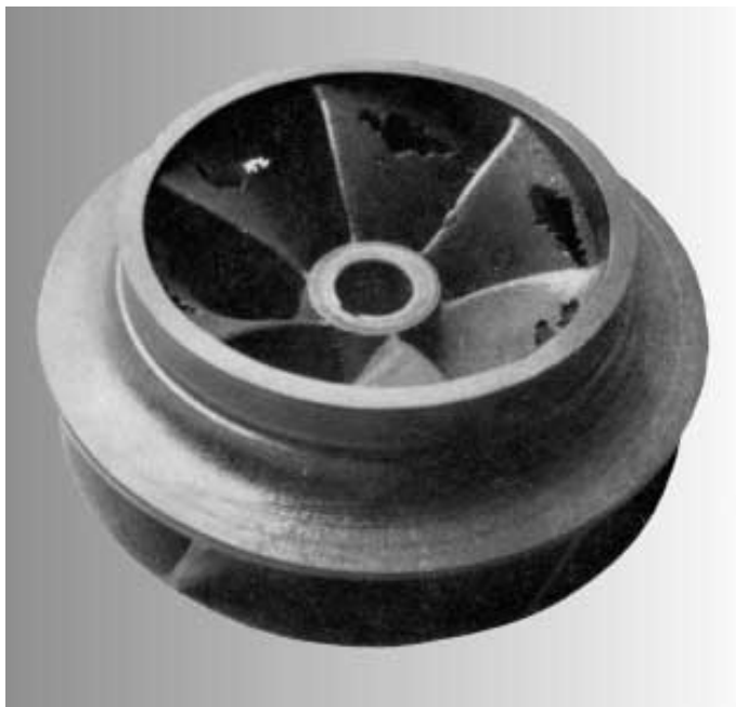
Durch Kavitation zerstörtes Laufrad einer Kreiselpumpe
