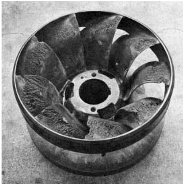
Durch Kavitation erodiertes Laufrad einer Francis turbine
