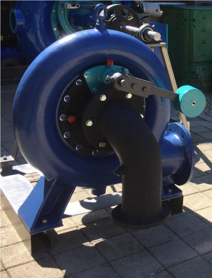
Kleine Francisturbine Maschinenfabrik Rapperswil, Bj. 1912, innenreguliert, zum Ausstellen.
