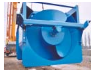
Neue Technologien für Ultra-Niederdruck gesucht: Wasserkraftschnecke in Derendingen (Th. Köhli)
