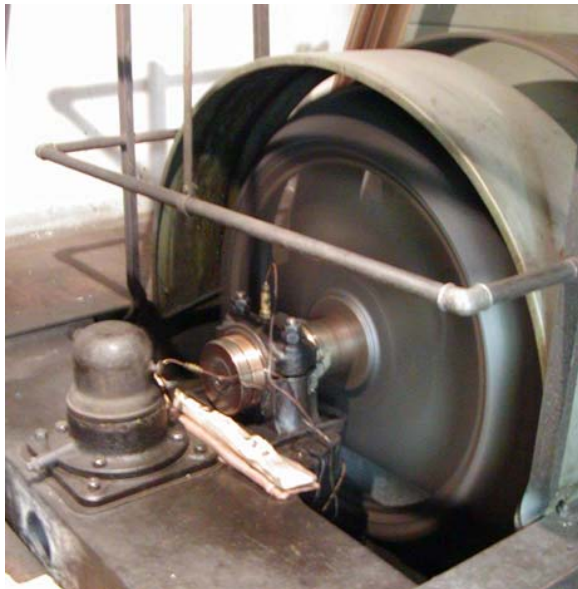
Besichtigung Wespimühle: Revidiertes Win-kelgetriebe zum Überführen der Energie in die Mühle
